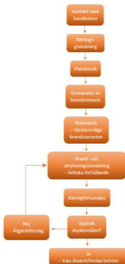
Figur 1. Schematisk bild över arbetsgång från första handledarkontakten till färdigt åtgärdsförslag.
