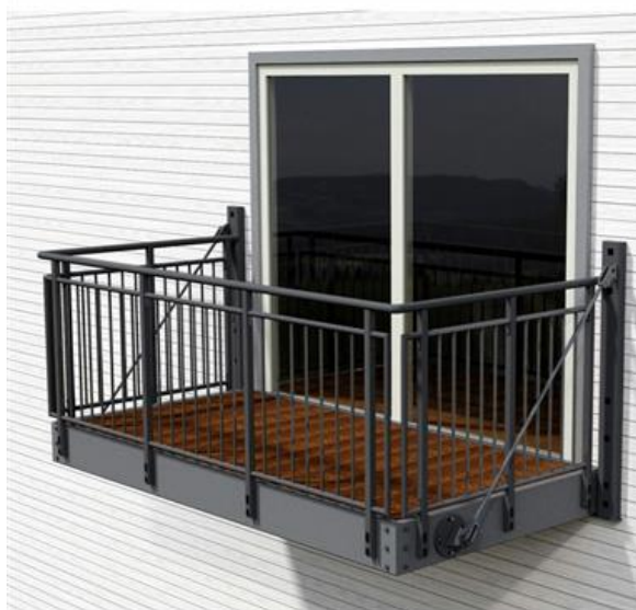
Figur 3.1 Exempel på öppen balkong upphängd med dragstag. Källa: (BIM Objects, 2015).
