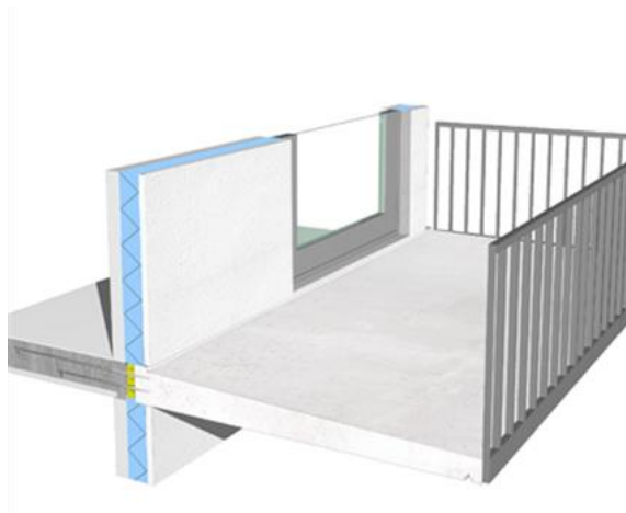
Figur 3.3 Exempel på fast inspänd balkong. Källa: (Byggkatalogen, 2017).
