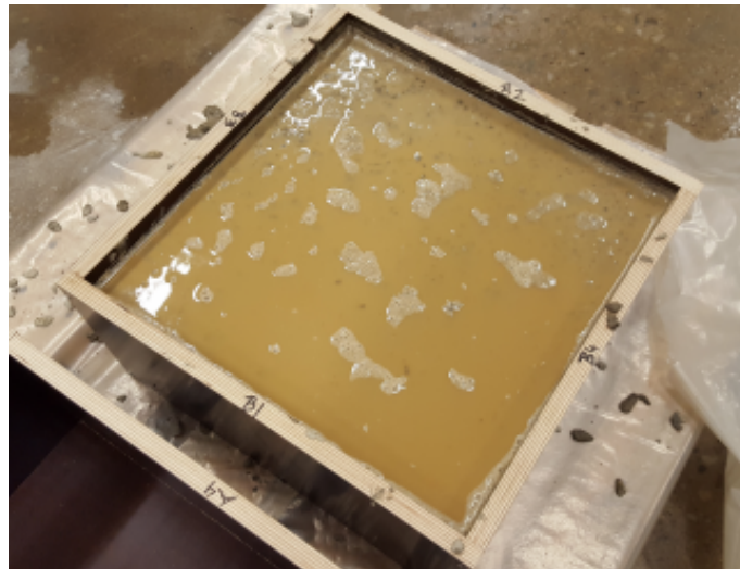
Figur 3.1: Vattenseparation i betongen med CEM I utan luftporbildare samt formen som betongen göts i.
