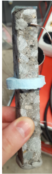
Figur 3.14: Provkropp inför det andra testet med glas på toppen, termoelement, gördel och tätning längst ner.
