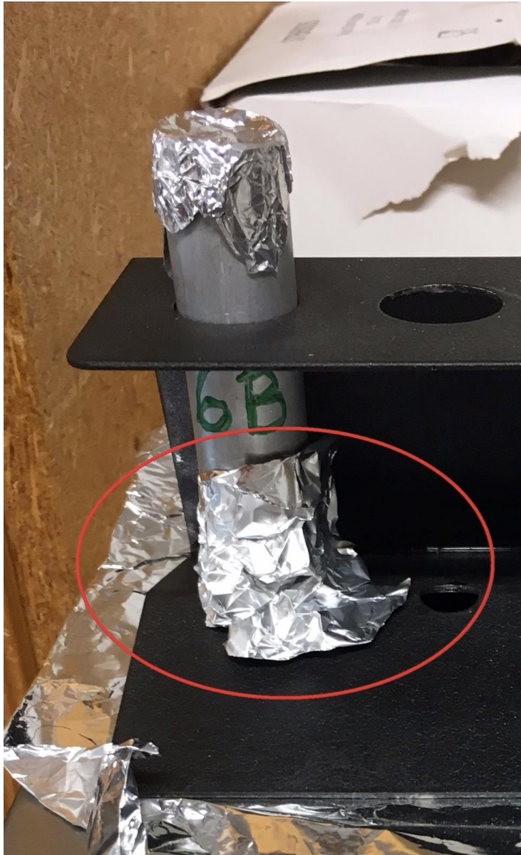
Figur 17. Provrörshållare med provrör i vid uppvägning. Provrörshållaren står på en våg och aluminiumet som är inringat används för att förhindra uppstigning av provrörshållaren.
