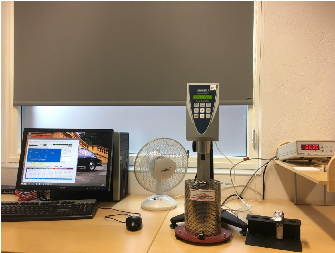
Figur 14. Rotationsviskosimeter, RVB, som användes i laboratoriet vid Lunds Tekniska Högskola.
