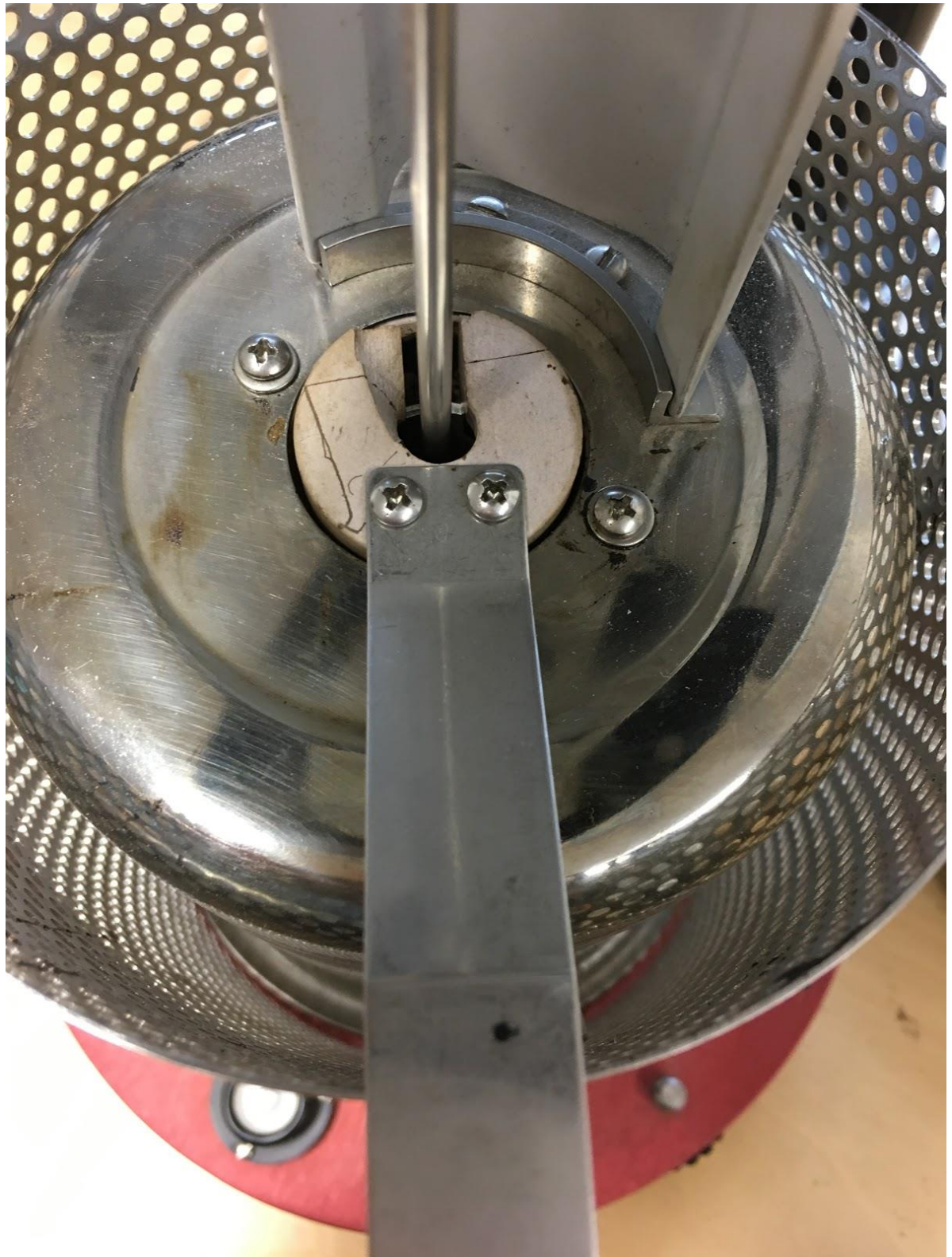
Figur 27. Lock som läggs över provröret under körning.
