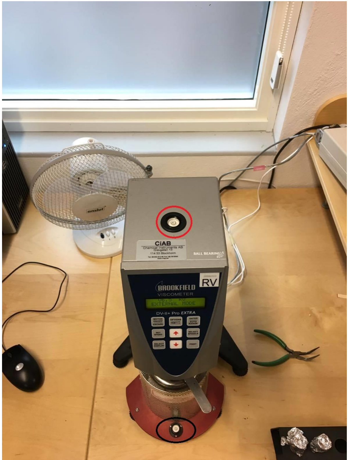
Figur 25. Korrekt inställning av både RVB och badet. Notera att bubblan är i mitten i båda ringarna.
