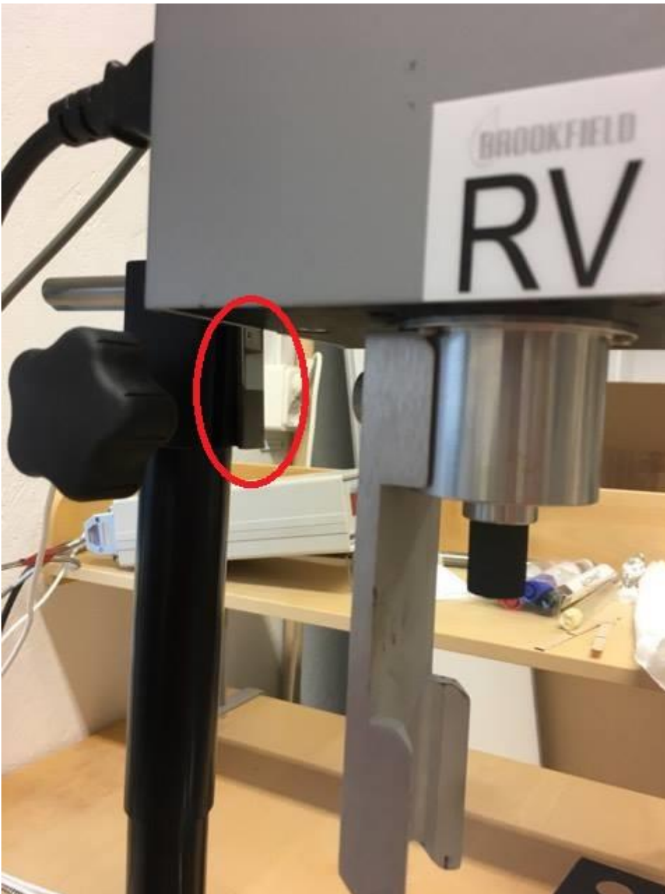
Figur 24. Spaken för att sänka och höja RVB maskinen med.
