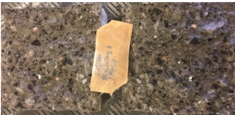
Figur 25. Blandning 3 efter den testats mot spräckhållfasthet.
