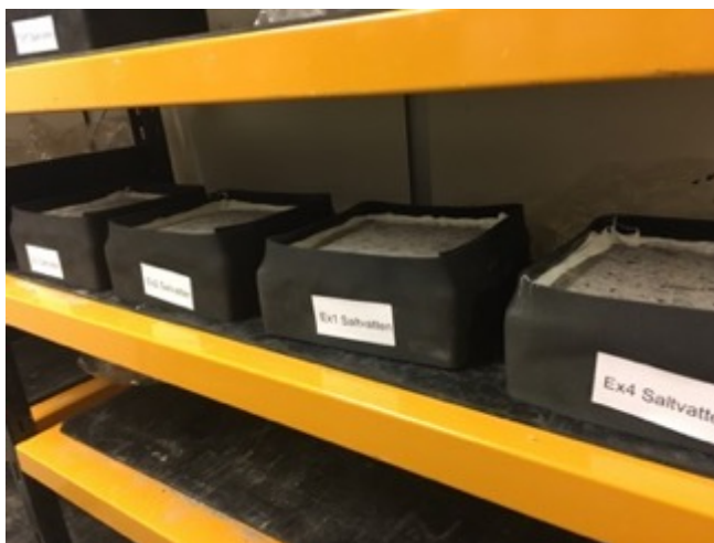
Figur 16. Limmade betongskivor i klimatkammaren.
