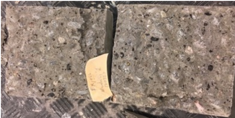
Figur 23. Blandning 1 efter den testats mot spräckhållfasthet.
