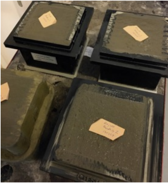
Figur 13. Kubformer nyss fyllda med betongblandning 2.
