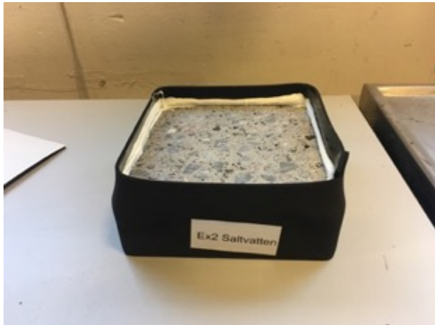
Figur 15 Limmade gummidukar runt betongskivans alla sidor förutom frysytan.
