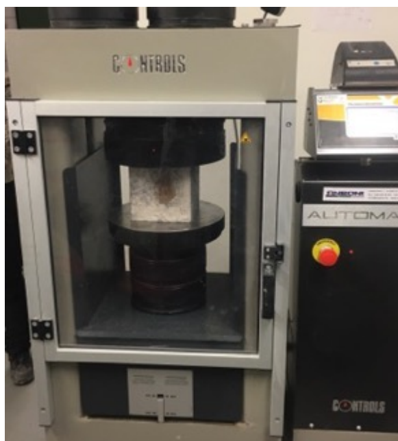
Figur 18. Testar tryckhållfastheten för en provkropp.
