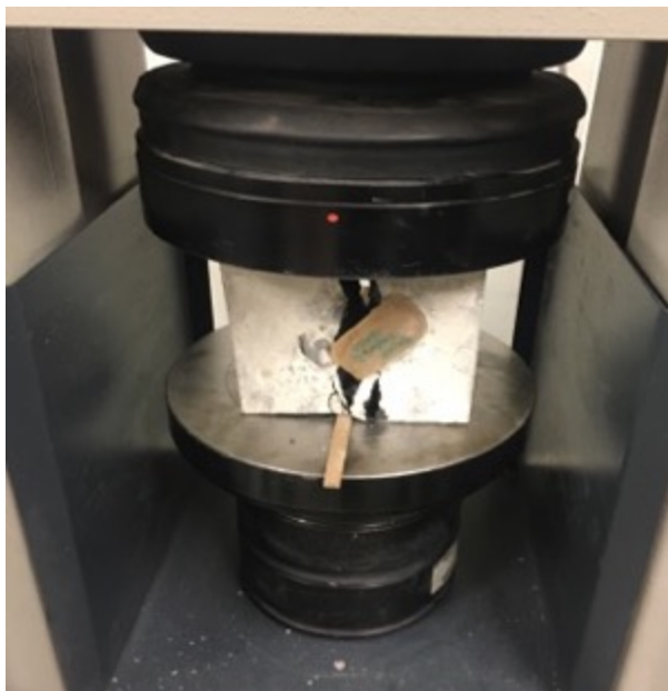
Figur 19. Testar spräckhållfastheten för en provkropp.
