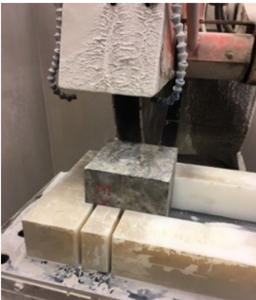
Figur 14. Sågning av kuben för att skapa en frysytta i mitten.
