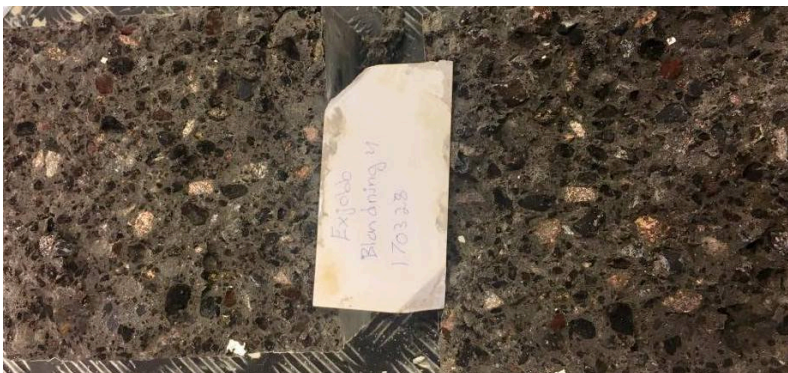
Figur 26. Blandning 4 efter den testats mot spräckhållfasthet.
