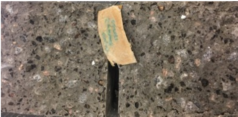
Figur 24. Blandning 2 efter den testats mot spräckhållfasthet.
