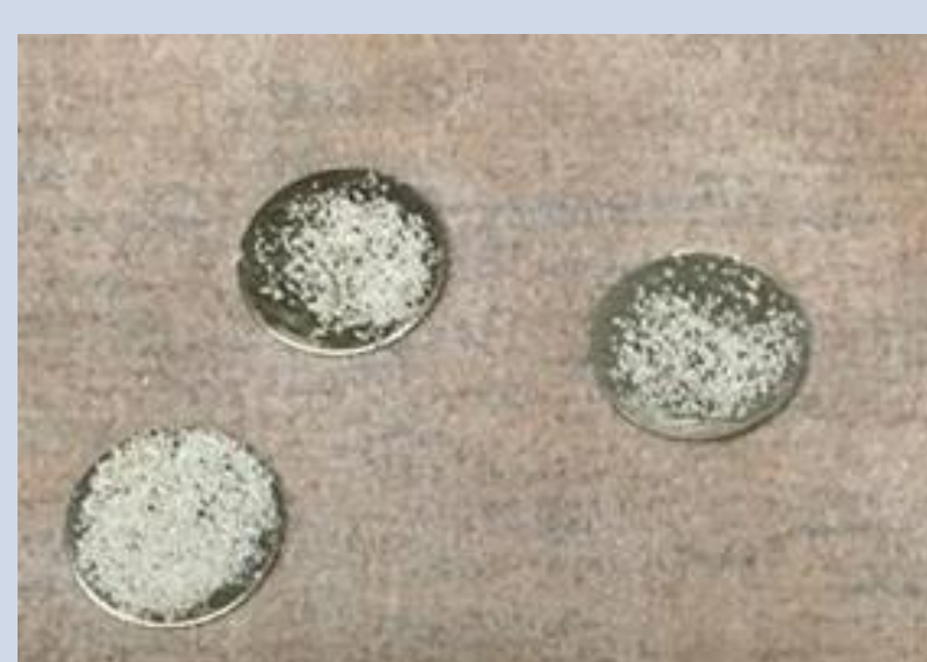
Figur 2. Kvartsprover placerade på metallbrickor inför OSL-analys
