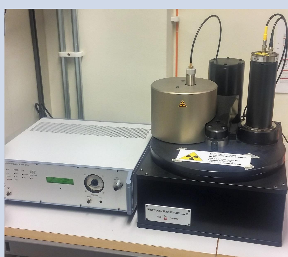
Figur 4. OSL-reader, Risø TL/OSL DA-20 i Lunds luminiscenslaboratorium. En optisk ljuskälla ( blå LED, light emitting diode) används för att generera luminiscenssignaler.
