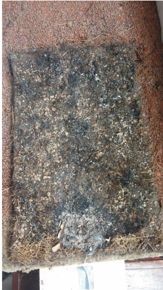
Figur 39: Brandspridning över provkropp vid försök 21, helt avbränd vegetation.
