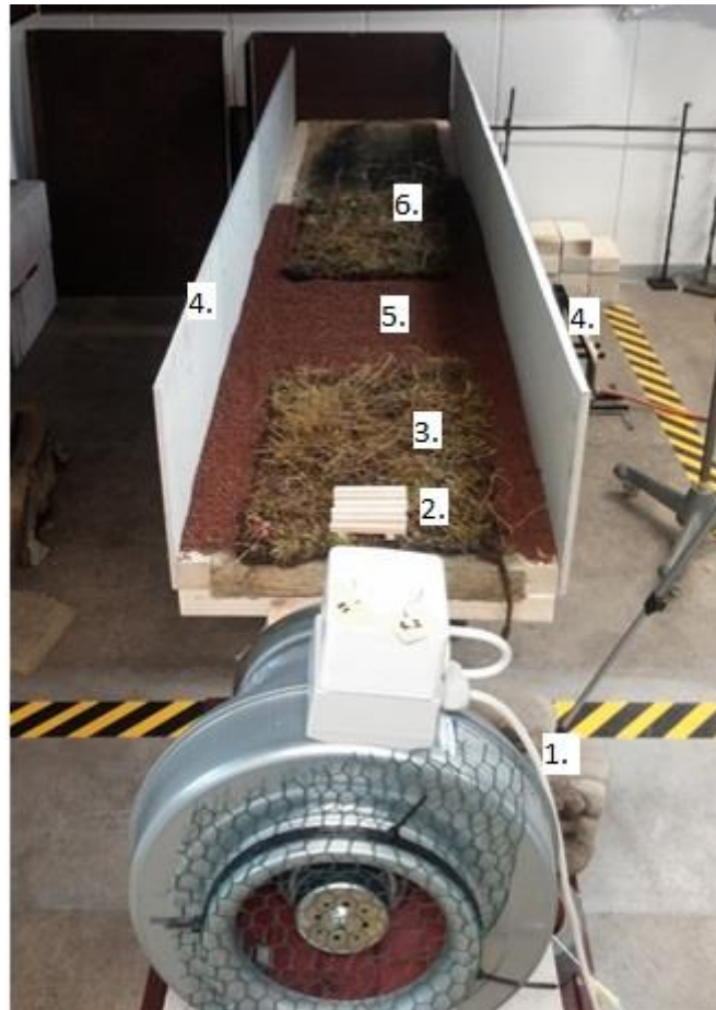
Figur 32: Uppställning för spridningstest, sedd ur vindriktningen
