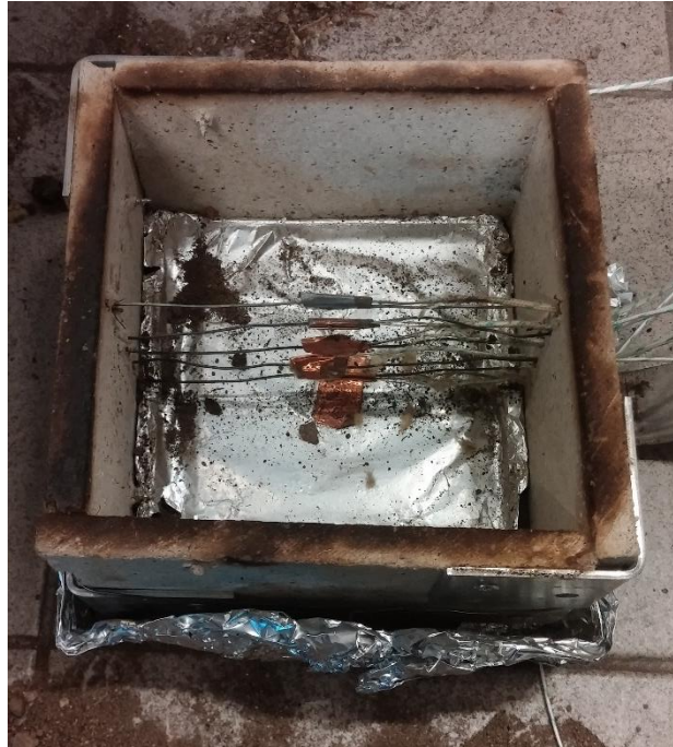
Figur 28: Tom sampleholder med termoelement på olika nivåer.
