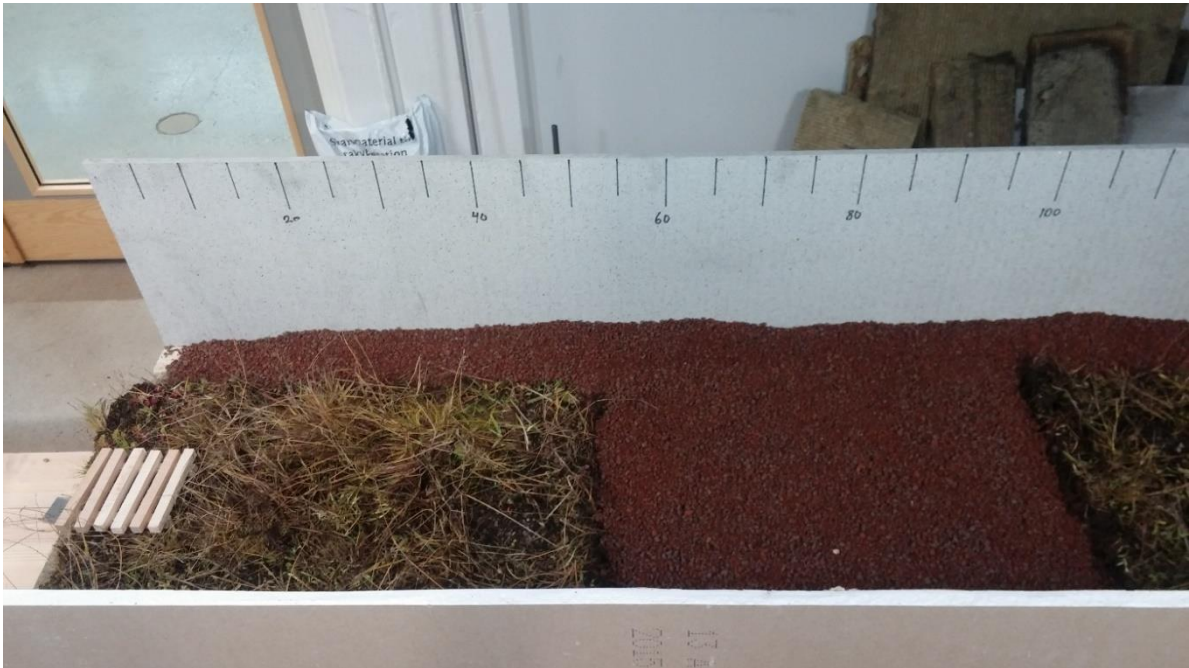
Figur 31: Uppställning för spridningstest, sedd ur profil
