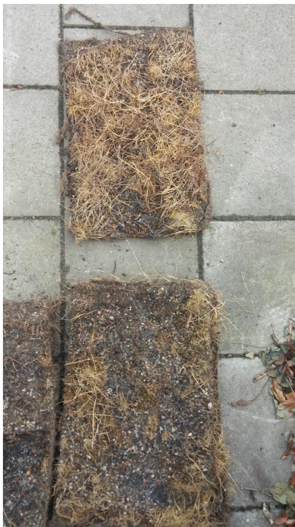
Figur 38: Brandspridning över provkroppar vid försök nummer 17. Mottagande provkropp överst i bilden med brandpåverkat område av ca 15 cm.
