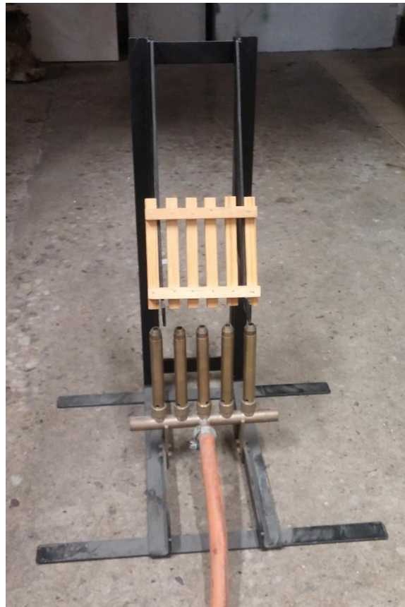
Figur 30: Antändningsrigg för träribbstapel
