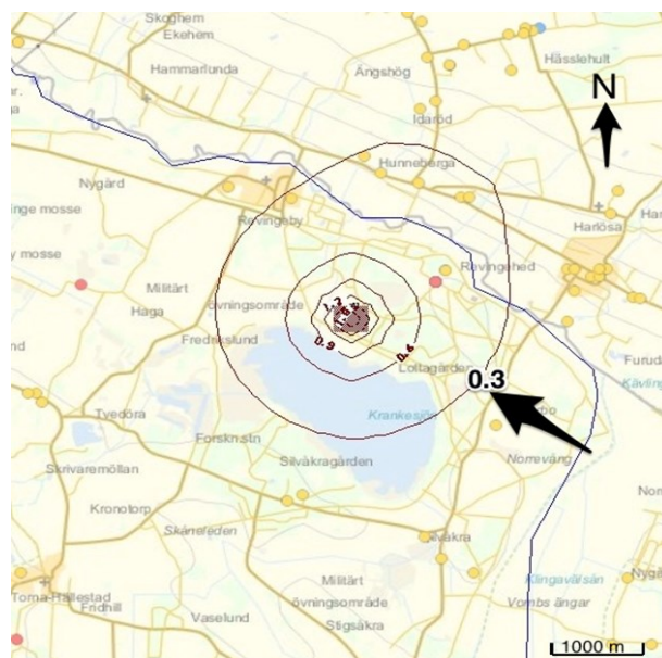
Fig. 10. Modellering 1. Beräknat influensområde för kalksandstensberggrunden (akvifär 2). Influensområdet i berggrunden identifieras som det område där avsänkning är 0,3 meter eller mer.
