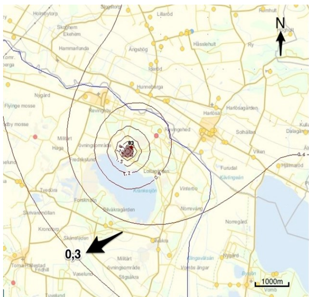
Fig. 11. Modellering 2. Beräknat influensområde för kalksandstensberggrunden (akvifär 2) där avsänkningen är 0,3 meter eller större. I denna modellering har det använts ett lägre värde på den hydrauliska konduktiviteten för akvikluden jämfört med den i modellering 1.
