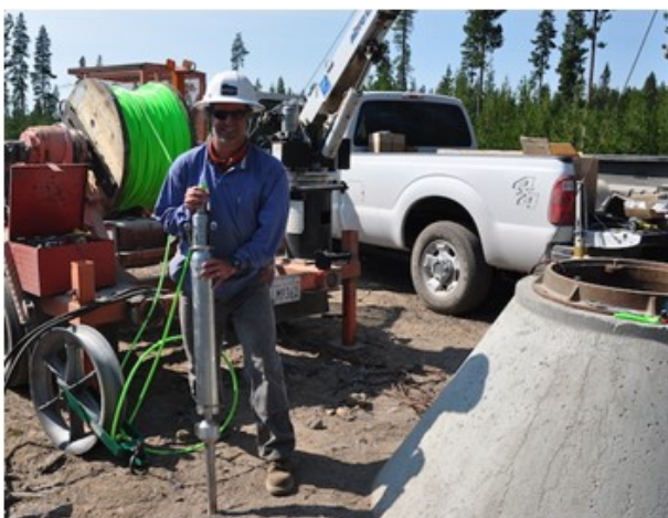
Fig. 13. Seismometern används för mikroseismisk övervakning i borrhålet under stimulationsfasen. Foto från (AltaRock 2014)
