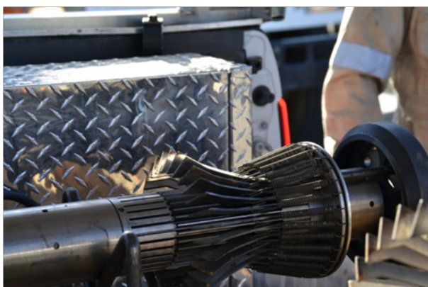
Fig. 16. Multiarmad Caliper för spricklokalisering och undersökning av foderrör. Foto från Altarock Energy (2014)
