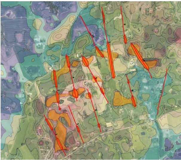
Fig. 21. Områdeskarta med topografi som visar profiler samt högresistivt lager i orange som tolkas som sand/grus. De svagt gula områdena visar tolkning av hur lagerna kan breda ut sig i området efter topografi och geomorfologi. Baggrundkort: © Kortforsyningen | Styrelsen for DataForsyning og Effektivisering. Modifierad av Hanna
