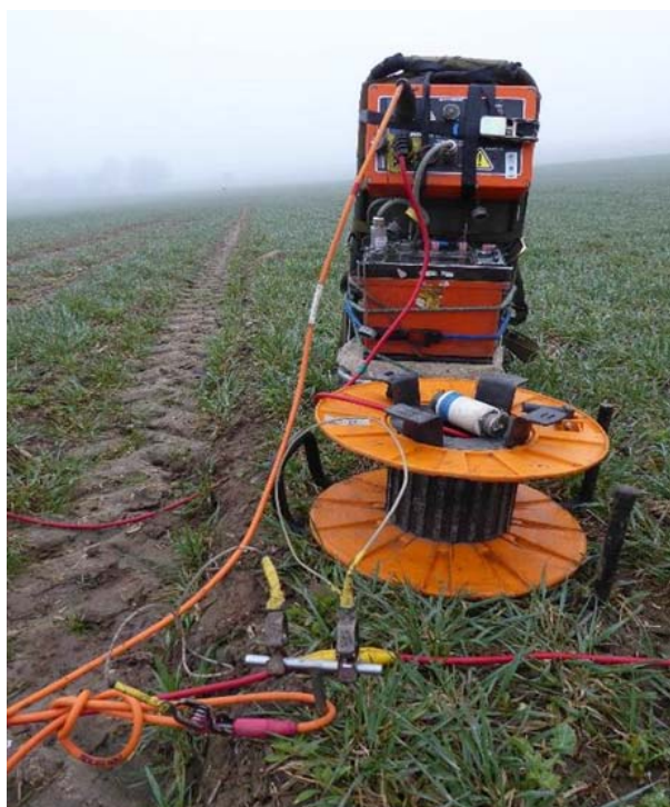
Fig. 7. Foto som visar MEP instrumentet, ABEM SAS4000 Terrameter som läser av och styr resistivitetsmätningen, en kabelrulle och jumper som är ihopkopplade till elektrod. Foto: Hanna Nilsson 2017
