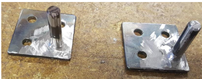
Figur 81: Förstärkta fästen till det andra testet
