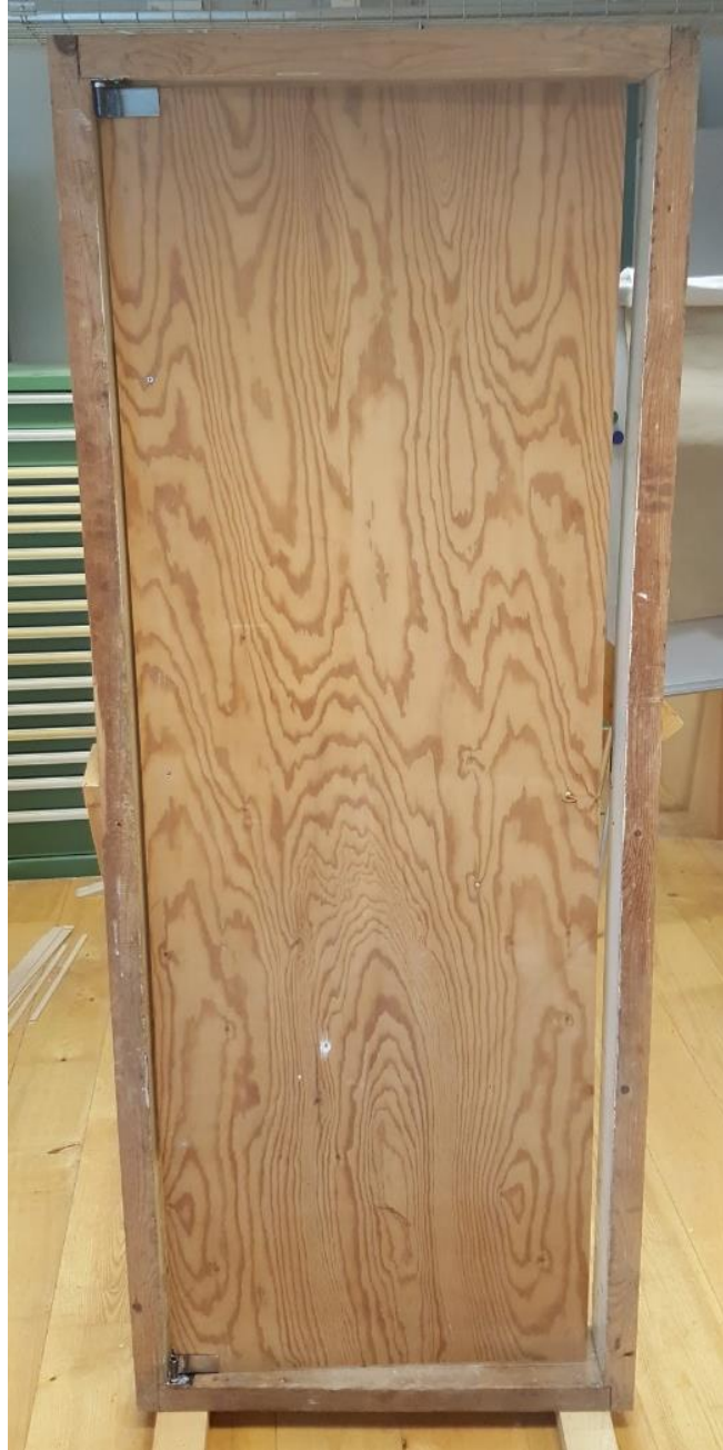
Figur 82: Testrigg med monterad dörr
