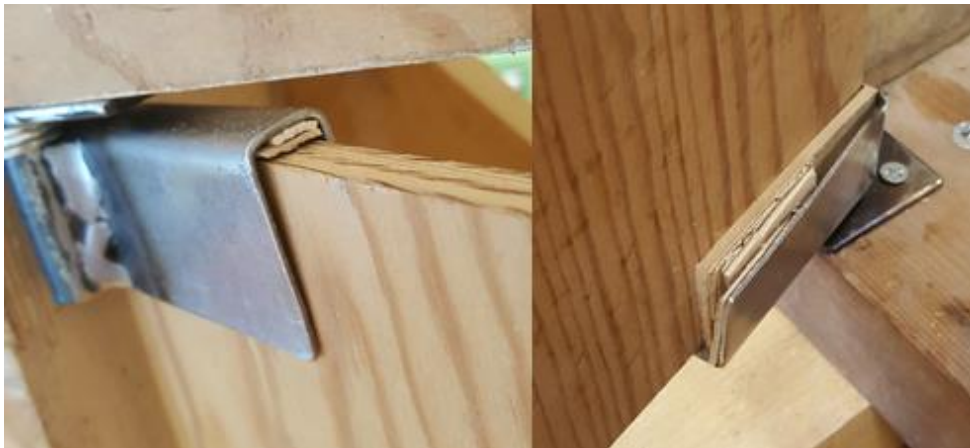
Figur 84: Monterad prototyp med kilar för fastsättning. Hållaren viker sig utåt något (t.h.)
