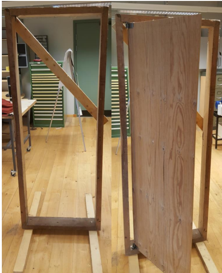
Figur 80: Testrigg utan monterad dörr (t.v.) och med monterad dörr (t.h.)
