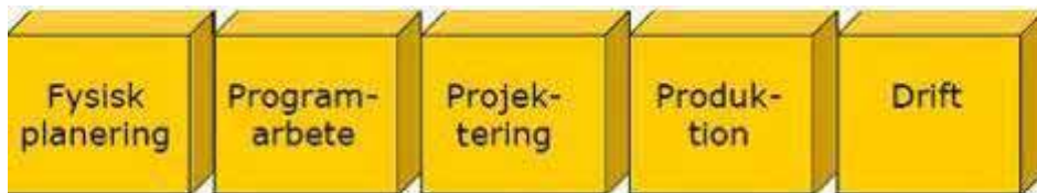
Figur 2.3 Den traditionella byggprocessen (www.byggmaterialindustrierna.se)
