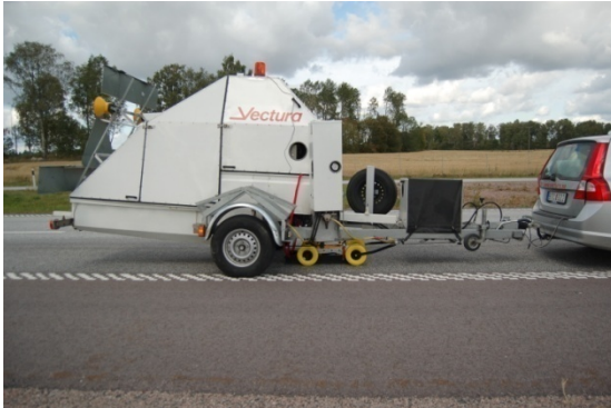
Bild 1.1 Mätfordon med fallviktsutrustning(Vectura). (källa: Mårtensson, 2010)
