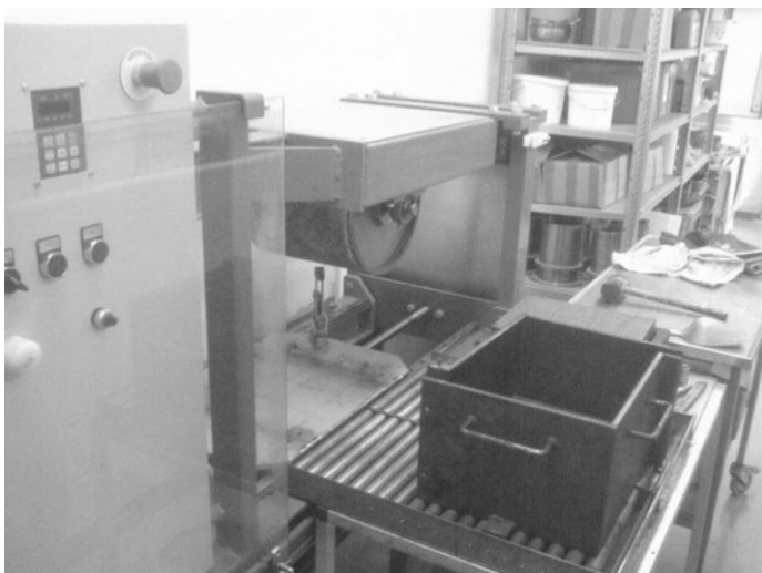
Figur 3.4 Pankas packningsutrustning med stålform och packningshjul.
