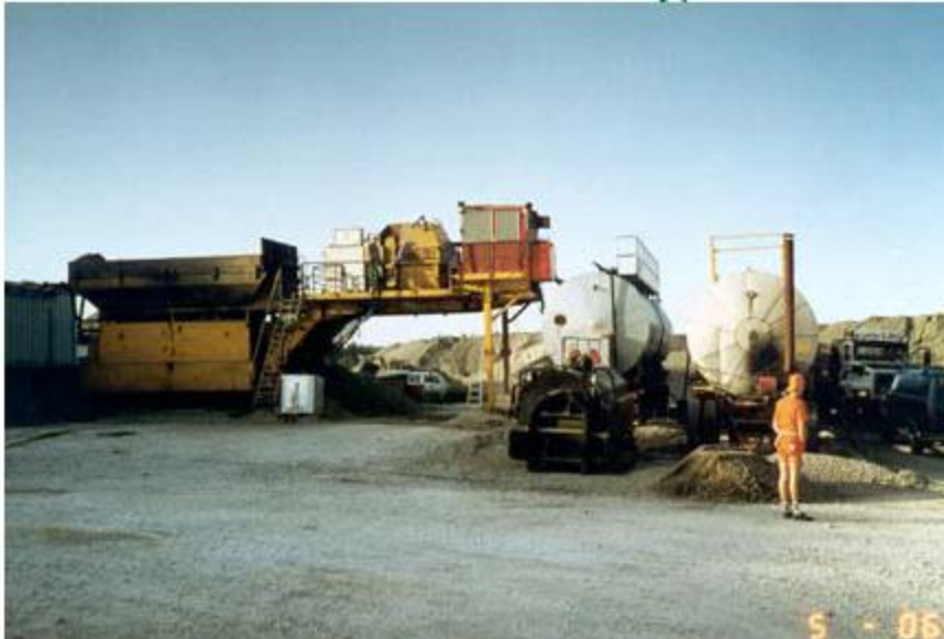
3-1 Halvvarm återvinning i verk (Jacobson, 2001)
