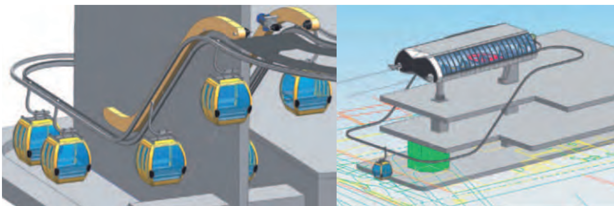
Figur 3.9 Principskisser för station där gondoler transporteras ner till markplan (WIR, 2010)
