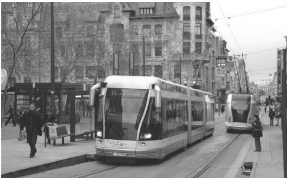
Figur 17. Spårbussystem med mitträrl i franska Nancy (Andersson & Gibrand 2008)
