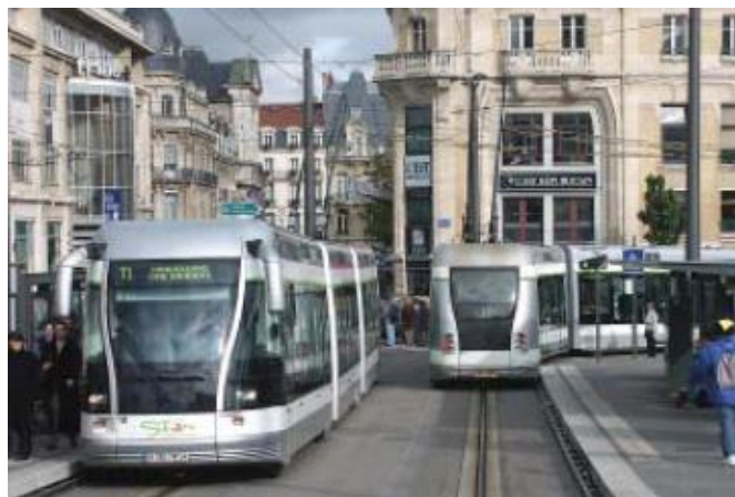
Figur 13 - Exempel på gummispårvagn med styrskena och elförsörjningskabel (Johansson, 2004)
