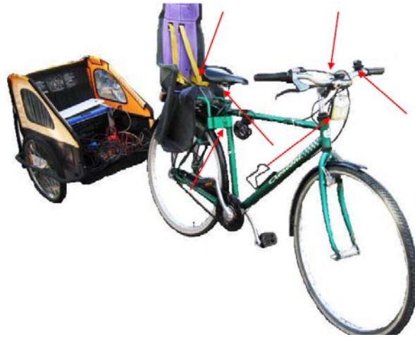
Figur 4.4 Cykel utrustad med accelerometrar. Accelerometrarnas placering illustreras av pilarna i figur (Nilimaa, 2009).
