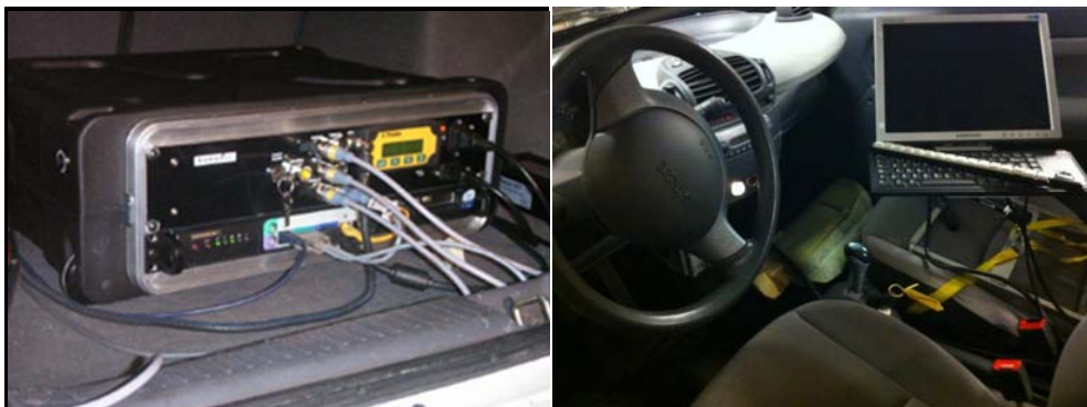
Figur 5.2 Till höger syns mätutrustningens systemlåda och till vänster en monitor med tangentbord samt knappdosa (Foto: Carl Ossbahr).
