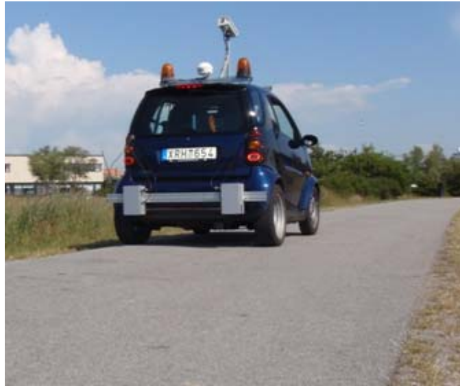
Figur 5.1 Två sensorboxar, innehållandes en laser och accelerometer, fästa vid den balk som finns monterad baktill på mätfordonet (Ramböll, 2008).
