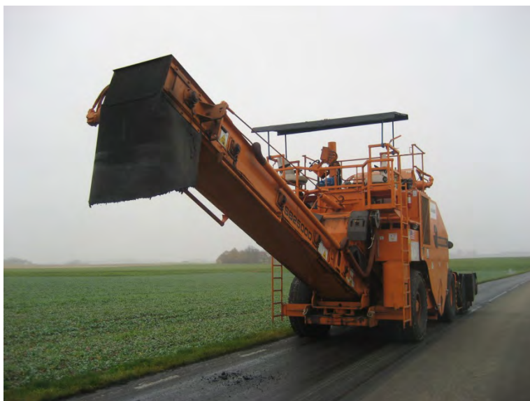
Figur 4.8. Shuttle-buggyns arm till asfaltläggaren kan svänga i sidled. ©Författarna
