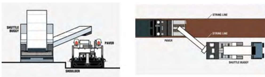
Figur 4.9. Princip vid sidolastning med shuttle-buggy. (Roadtec, 2010b)
