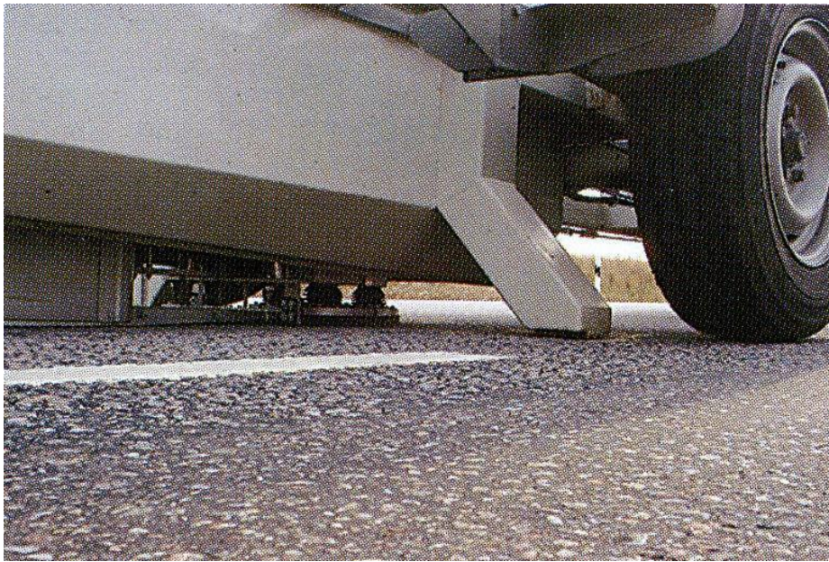
Figur 9 - Närbild på fallviktsplatta (SKF, 2003).
