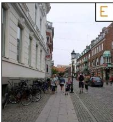
C. Kantstenen är inte avfasad till 0-nivå. Trångt utrymme framför passage samt smal trottoar vid sväng.
