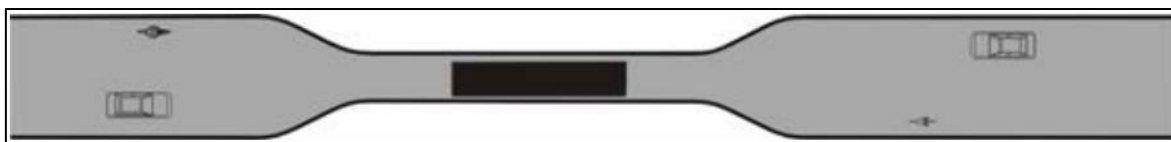
Figur 2.6. Timglashållplats. Källa: (Vägverket, 2004)
