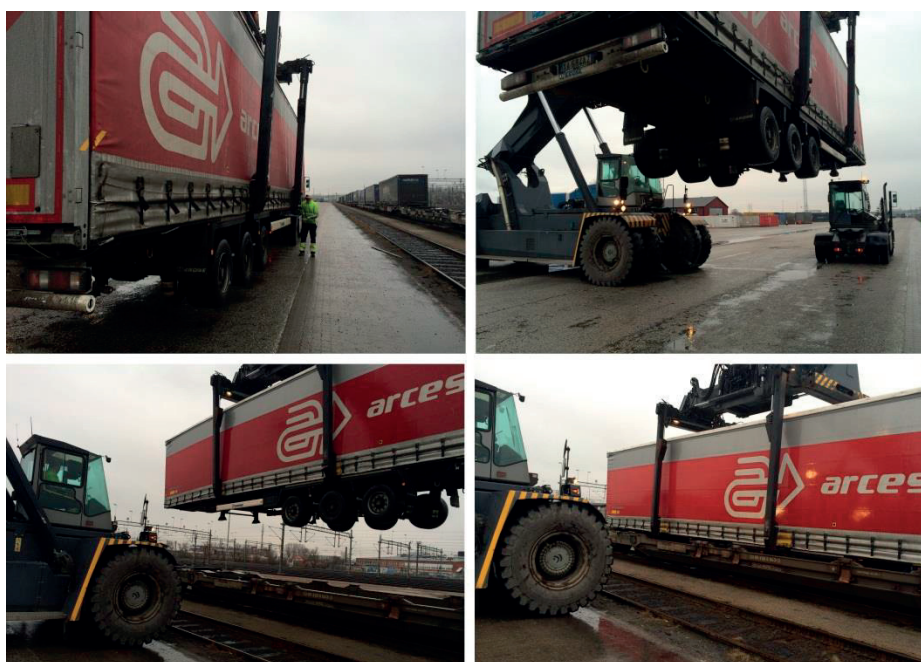
Figur 6-49: Vanligen ställs semitrailrar upp bredvid rätt tågsvagn av dragtruckar eller lastbilar och lyfts på plats med reachstackers. Semitrailern i figuren är av typen "Megatrailer" som har mindre hjul och större lastvolym än vanliga semitrailrar. Megatrailrar lastas på speciella tågsvagnar för att inte överskrida lastprofilen.
