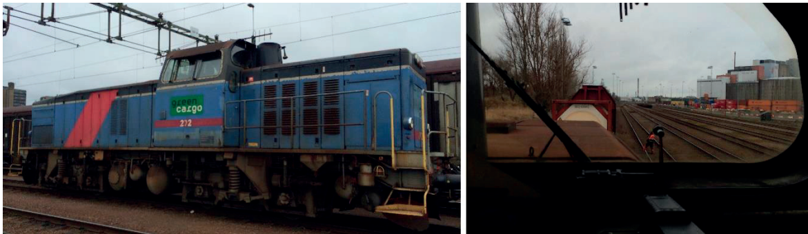
Figur 6-34: Green Cargo har egna dieseldrivna växlingslok som genom fjärrstyrning kan köras även när växlingspersonalen står utanför loket.
