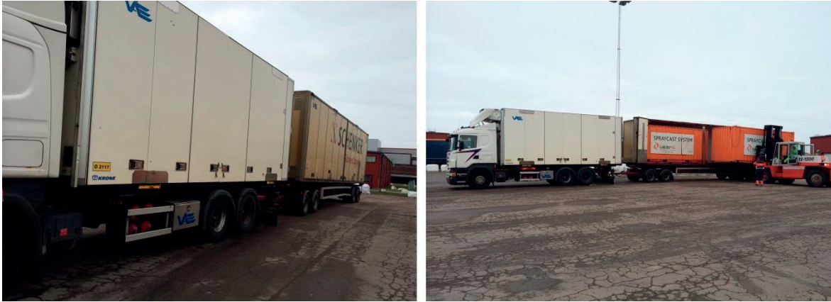
Figur 6-38: Vikströms lastar och lossar med bil och släp vars flak sedan lyfts av och skickas på järnväg. Flaken är stora nog att lastas med ISO-containrar vid behov (höger bild). Fotona är tagna vid lastning på ett företag i Höganäs.
