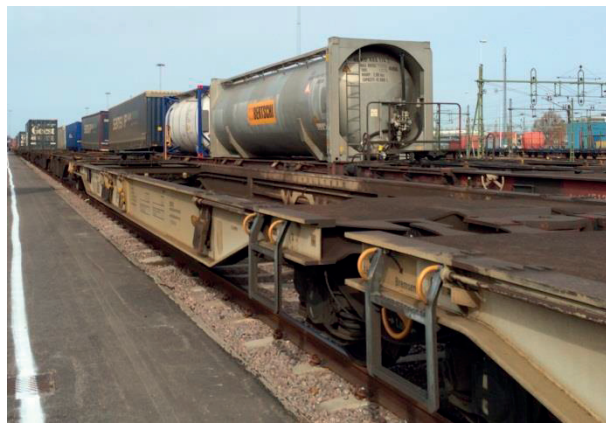
Figur 3-7: Tågsvagnssätt för intermodal trafik.
