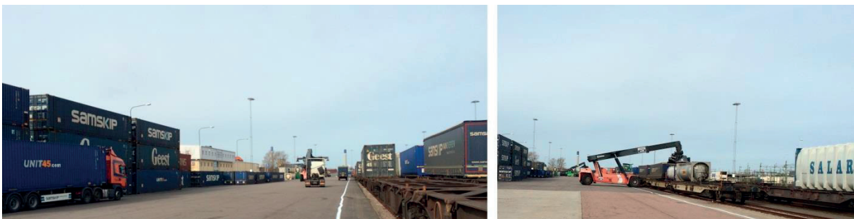
Figur 6-39: Truck- och lastbilstrafik går blandat inom området (vänster bild). Reachstackers når enheter på två hanteringsspår från varje sida. När yttre tågsättet är tomt lyfts enheter från nästa spår ut över det närmsta spåret (höger bild).
