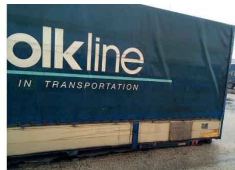
Figur 3-4: Växelflak med kapell. Stödbenen är infällda vid färd och vid vertikal hantering.
