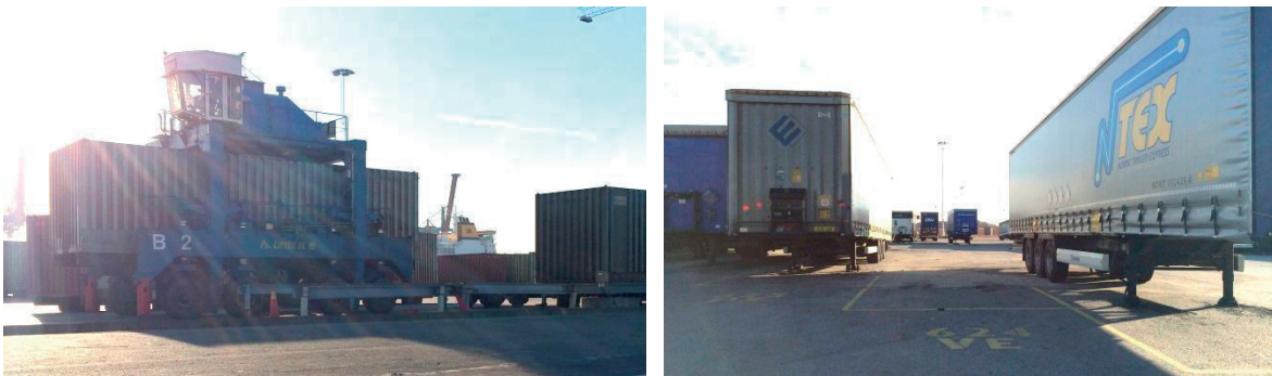
Figur 6-12: T.v. en låglyftande grensletruck vid kombiterminalen. T.h. uppställningsplats för semitrailrar med platsnummer och kontrollkod målat på marken framför.
