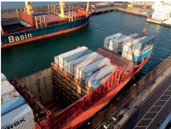
Figur 6-29: Kranföraren har alltid hjälp av två personer ombord på det fartyg som lastas. De ser till att containrarna hamnar rätt och att infästning sker på rätt sätt. Personalen har radiokontakt med kranföraren.
