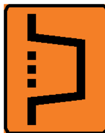
Figur 14- Orienteringstavla för omledning
