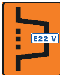
Figur 13 - Orienteringstavla för omledning med F15 infogat
