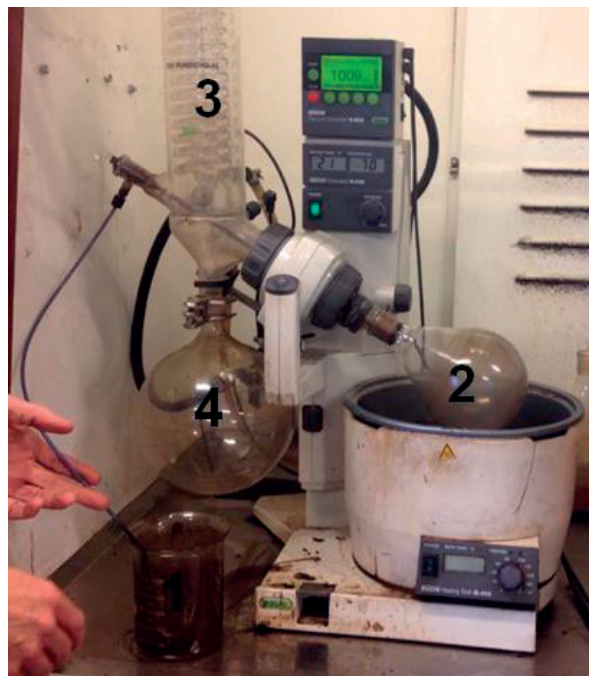
Figur 3-3: Avdunstning av diklormetan där bitumen som återvunnits samlas i behållaren i 2
