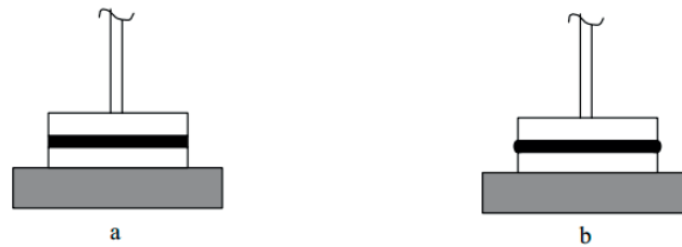
Figur 3-9: Provkropp efter trimning (a) samt efter sänkning till mätthöjd (Nordtest, 2002)
