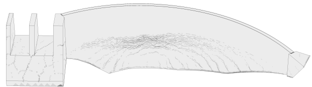
Figur 2: Sprickbildning på nedströmssidan.
