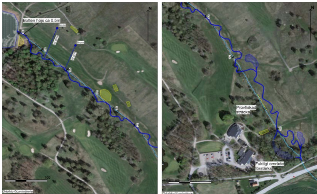
Figur 4. Ekologgruppens projektritning över Glomsbäcken. Till vänster visas den norra delen och till höger den södra. Ljusblå linje markerar den befintliga färan och mörkblå linje markerar den nya färan. Föreslagna groddammar är markerade i mörkblått, samt befintliga tees i gult (Wedding & Holmström, 2013).
