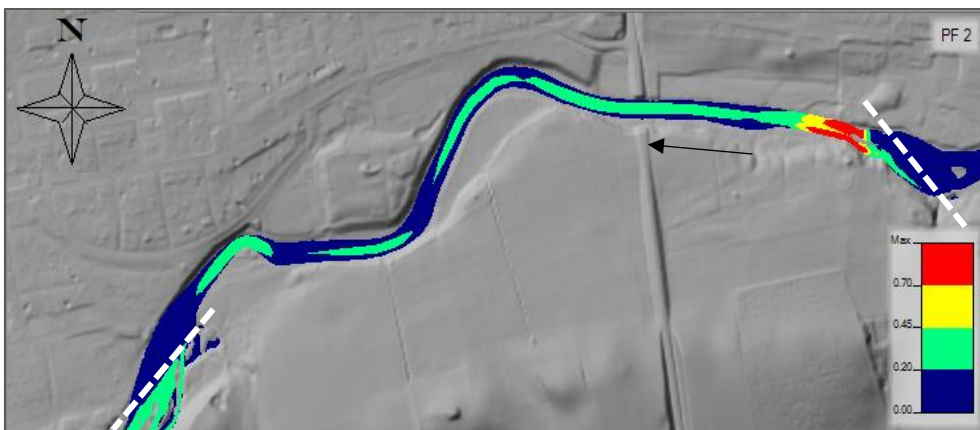
Figur 59 Strömshastigheter uppströms dämnet vid Silverforsen efter partiell utrivning, PU, sommartid, MQ, där blå är hastigheter under 0,2 m/s, grön är 0,2 – 0,45, gul är från 0,45 och röd är hastigheter över 0,7 m/s. De vita streckade linjerna visar dämmens position.
