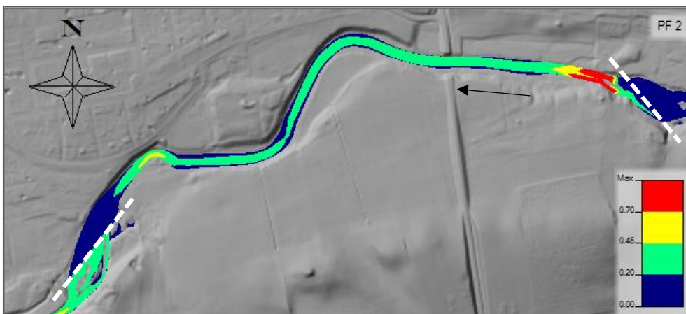
Figur 60 Strömshastigheter uppströms dämnet vid Silverforsen efter djupare partiell utrivning, D-PU, sommartid, MQ, där blå är hastigheter under 0,2 m/s, grön är 0,2 – 0,45, gul är från 0,45 och röd är hastigheter över 0,7 m/s. De vita streckade linjerna visar dämmens position.
