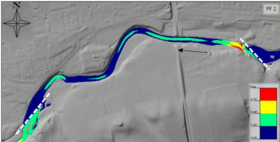
Figur 58 Strömshastigheter uppströms dämnet vid Silverforsen i dagsläget, sommartid, MQ, där blå är hastigheter under 0,2 m/s, grön är 0,2 – 0,45, gul är från 0,45 och röd är hastigheter över 0,7 m/s. De vita streckade linjerna visar dämmens position.
