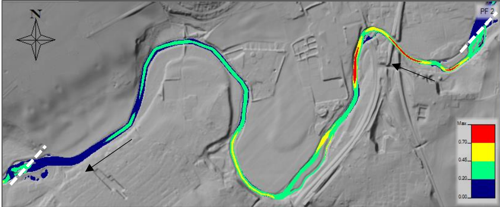
Figur 54 Strömshastigheter uppströms dämnet vid Högsmölla i dagsläget, sommartid, MQ, där blå är hastigheter under 0,2 m/s, grön är 0,2 – 0,45, gul är från 0,45 och röd är hastigheter över 0,7 m/s. De vita streckade linjerna visar dämmens position.
