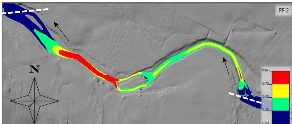
Figur 69 Strömshastigheter uppströms dämnet vid Bösmöllan vid djupare partiell utrivning, D-PU, sommartid, MQ, där blå är hastigheter under 0,2 \text{ m/s} , grön är 0,2 - 0,45 , gul är 0,45 och röd är hastigheter över 0,7 \text{ m/s} . De vita streckade linjerna visar dämmens position.
