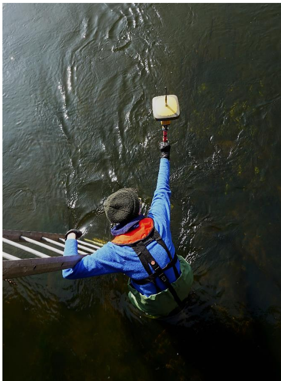
Figur 18 Inmätning av åbotten i samband med brosektion vid Krutmöllan.
