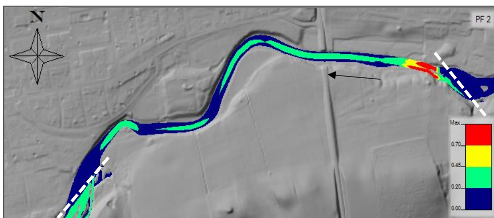
Figur 59 Strömshastigheter uppströms dämnet vid Silverforsen efter partiell utrivning, PU, sommartid, MQ, där blå är hastigheter under 0,2 m/s, grön är 0,2 – 0,45, gul är från 0,45 och röd är hastigheter över 0,7 m/s. De vita streckade linjerna visar dämmens position. Bakgrund från höjddata 2 m raster, © Lantmäteriet.
