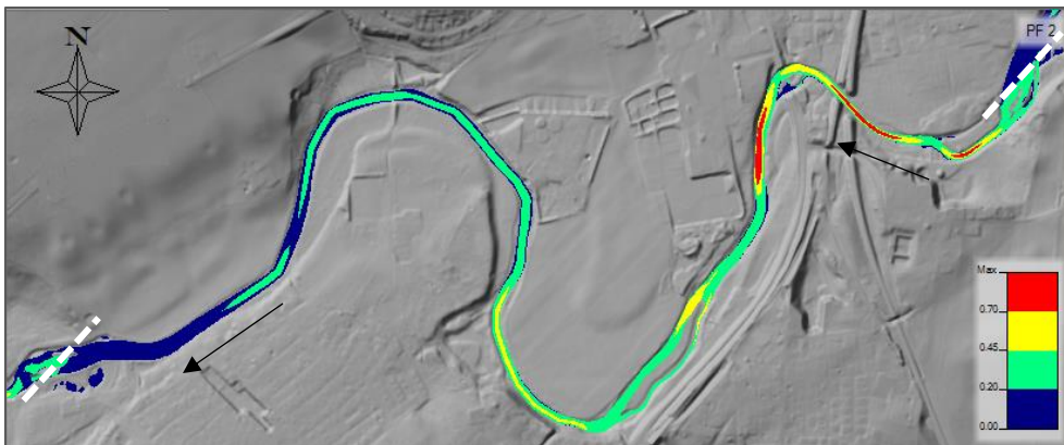
Figur 54 Strömshastigheter uppströms dämnet vid Högsmölla i dagsläget, sommartid, MQ, där blå är hastigheter under 0,2 m/s, grön är 0,2 – 0,45, gul är från 0,45 och röd är hastigheter över 0,7 m/s. De vita streckade linjerna visar dämmens position. Bakgrund från höjddata 2 m raster, © Lantmäteriet.
