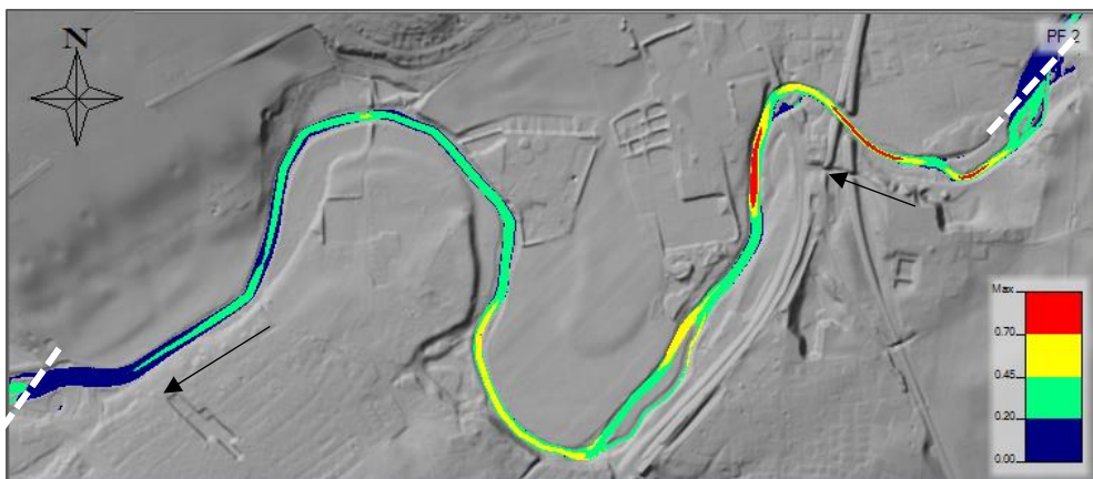
Figur 55 Effekt av partiell utrivning (PU) vid Högsmölla, sommartid, MQ. Blått representerar hastigheter under 0,2 m/s, grön 0,2 – 0,45, gul är från 0,45 och röd representerar hastigheter över 0,7 m/s. De vita streckade linjerna visar dämmens position. Bakgrund från höjddata 2 m raster, © Lantmäteriet.
