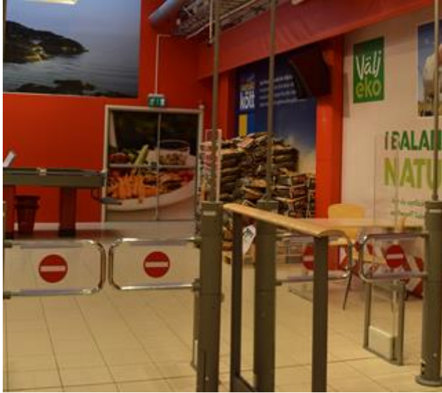
Figur 6. Exempel på ett missvisande motiv på utrymningsdörr. Bilden är tagen på ICA supermarket i Sjötelegrafens köpcentrum i Nynäshamn.
