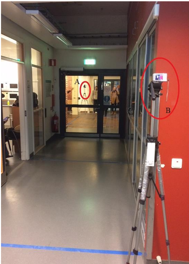
Figur 18. Placering av huvudkamerorna A och B i försökskorridoren.
