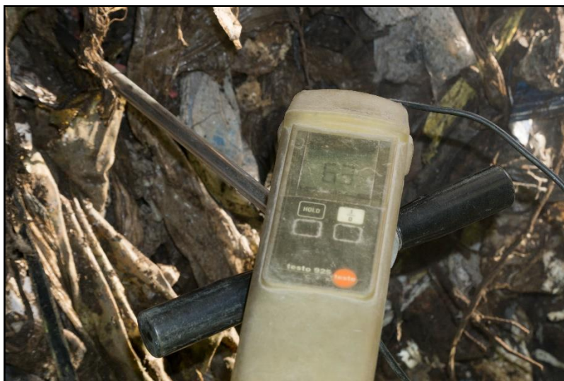
Figur 7. Under 4 veckors tid mätes temperaturen i både jord- och bränslefraktionen, på bilden ovan kan man se mätspjutet som användes vid temperaturmätningen instucket i bränslefraktionen (Bild: Samuel Svensson).
