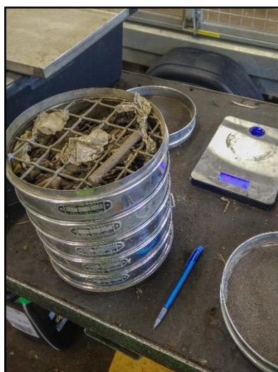
Figur 6. Handsiktingen skedde med hjälp av ett set av siktar som placerade spå varandra med minskade maskstorlek. Efter siktning vägdes och dokumenterades de uppsiktade fraktionernas (Bild: Samuel Svensson).
