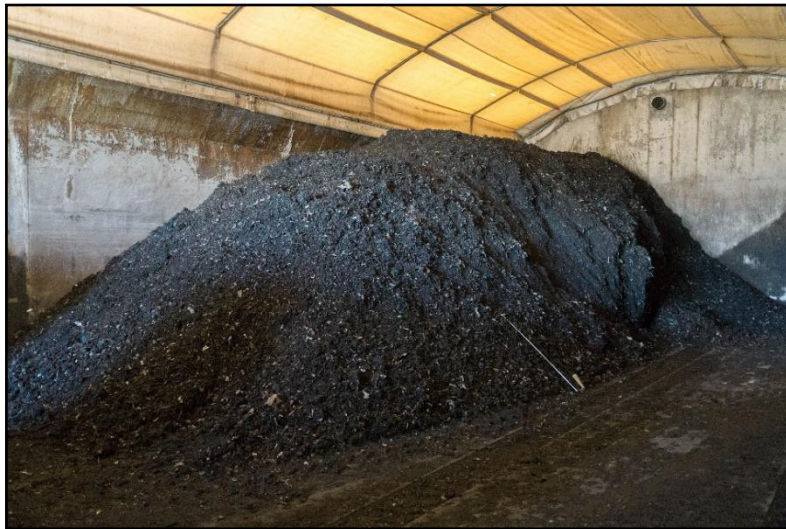
Figur 13. Bilden visar den jordfraktion som utskildes vid den första siktningen (Bild: Samuel Svensson).
