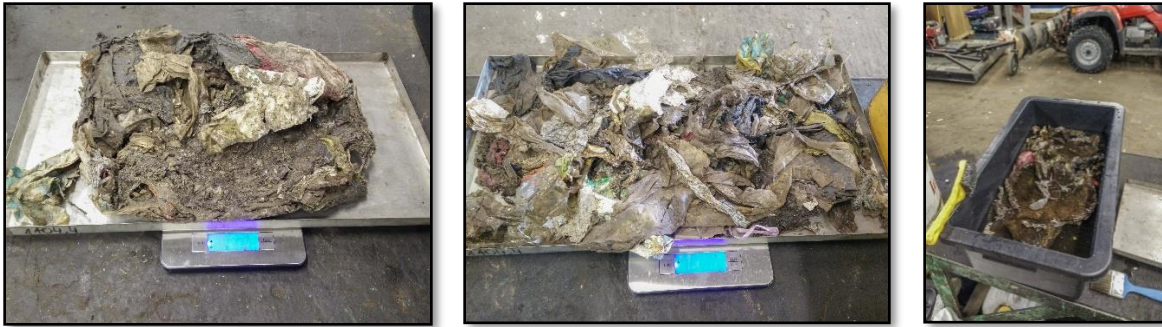
Figur 5. Bilderna ovan visar plastfraktionen före (vänster) och efter (mitten) tvätt. Vid jämförelse av bilderna kan man tydligt se ett högt jordinnehåll. På bilden till höger kan man se den anordning med vilket fraktionen tvättades. Större bilder finns att tillgå i bilaga 2. (Bild: Samuel Svensson).
