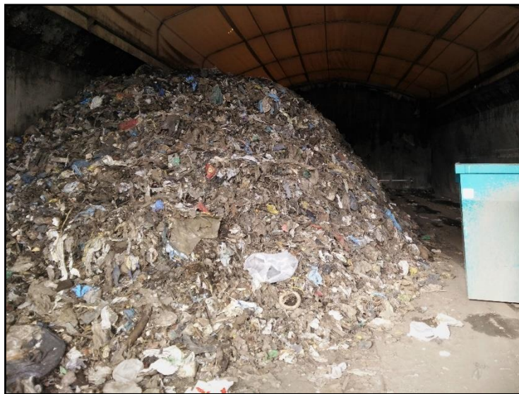
Figur 12. Bilden visar den brännbara fraktionen som utskildes vid den första siktingen (Bild: Samuel Svensson).
