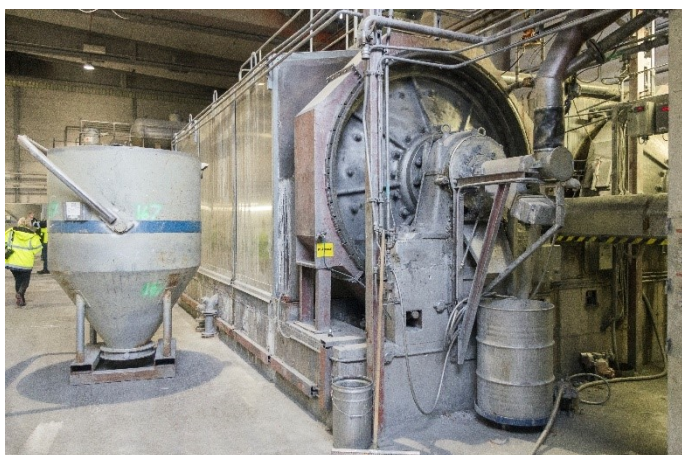
Figur 8: Kulkvarn i vilken materialet mals ner och lacknafta tillsätts.
