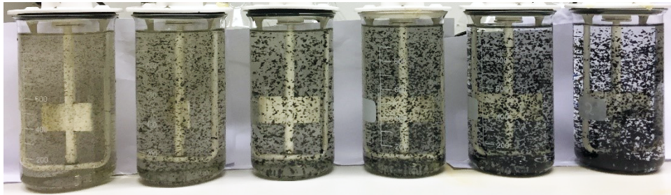
Figur 6.6. Bild från Test 1 där PAK, koagulant och polymer har tillsatts till vatten från biobädd, här under långsam omrörning. Enlitersbägarna innehåller de olika PAK-koncentrationerna, från vänster 10, 20, 30, 50, 150 och 300 mg/l.
