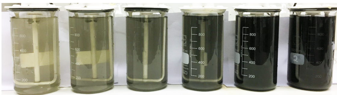
Figur 6.2. Uppställning av jar-test med PAK-koncentrationer (sett från vänster) på 10, 20, 30, 50, 150 och 300 mg/l i vatten från biobädd.
