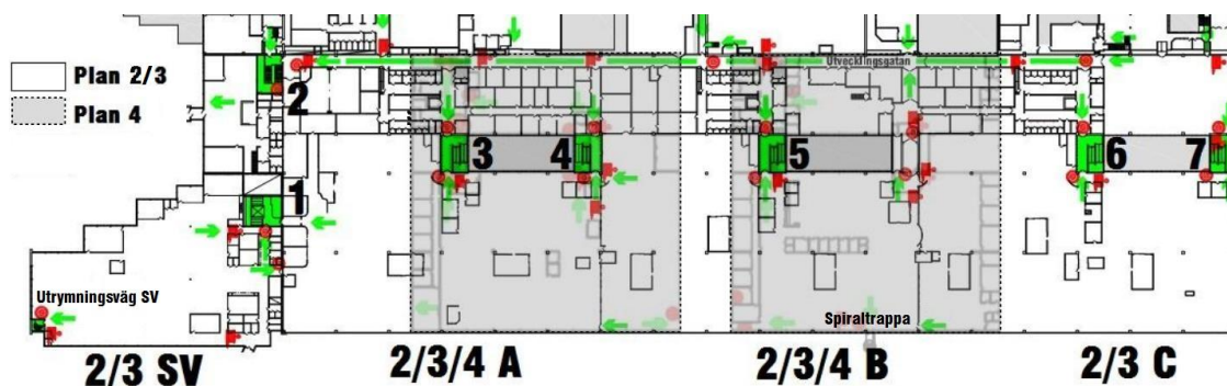
Figur 35. Trapphusens placering, samt spiraltrappan från 4B och utrymningsväg i SV.
