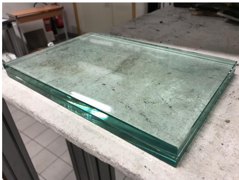
Figur 19. Två härdade glas efter avslutade försök. Inga visuella skillnader kunde noteras jämfört med innan försöken.
