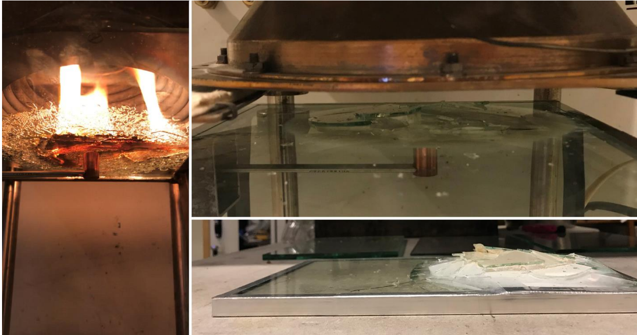
Figur 13. I bilden till vänster syns hur lamineringen börjar brinna i ett 6,76 mm lamellglas. Glaset utsattes då för en strålningsnivå på 25 kW/m 2 och lamineringen började brinna efter 6 minuter och 30 sekunder. I bilden uppe till höger syns hur ett EW30-glas har en synlig vit ring efter aktivering. Materialet har dessutom börjat expanderat och pressat sönder glaset. I bilden nere till höger syns det i profil hur samma glas ser ut efter avslutat försök.
