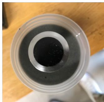
Figur 25 visar placering av provkropp PP25 (Sulejmani & Andersson, 2014).
