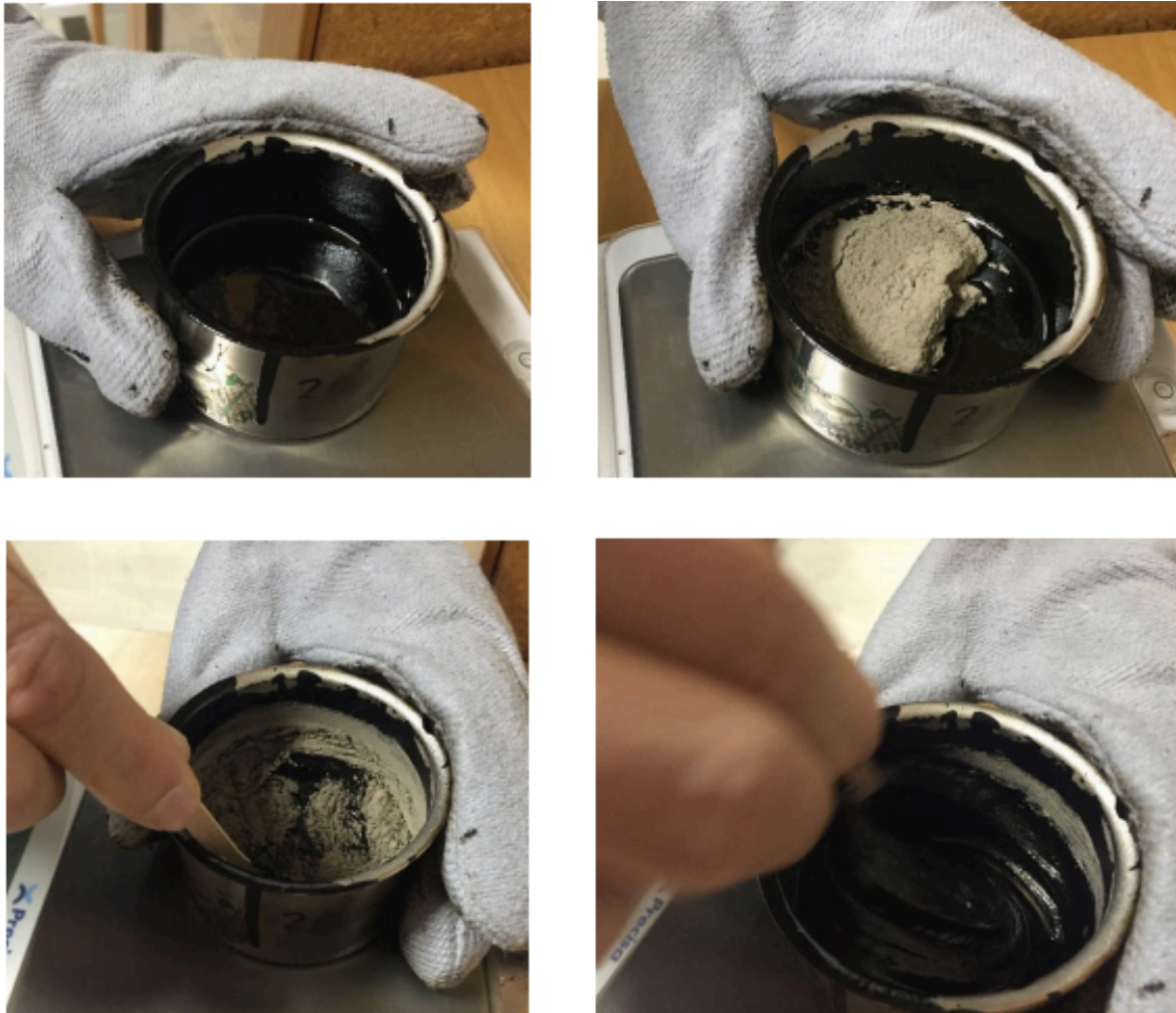
Figur 23 visar blandningsstegen av bitumen och filler (Håkansson & Härstedt, 2015).
