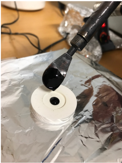
Figur 24 bilden till höger visar upphällning av bitumen. Bilden till vänster upphällning av bruk.
