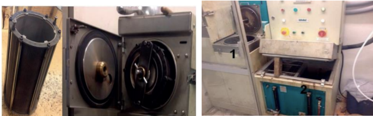
Figur 21 visar till vänster masknät och trumma, samt till höger visar figuren centrifug vid nummer 1 samt avtappning av bitumen och lösningsmedlet vid numer 2 (Sulejmani & Andersson, 2014)
