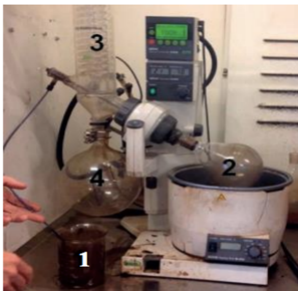
Figur 22 visar destillationsprocessen, blandningen suggs upp från 1 till 2 där den värms upp och förångas till 3, där den kyls ner till 4 (Sulejmani & Andersson, 2014)
