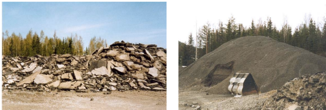
Figur 4 visar asfaltsjok till vänster och asfaltgranulat till höger (Trafikverket, 2004).
