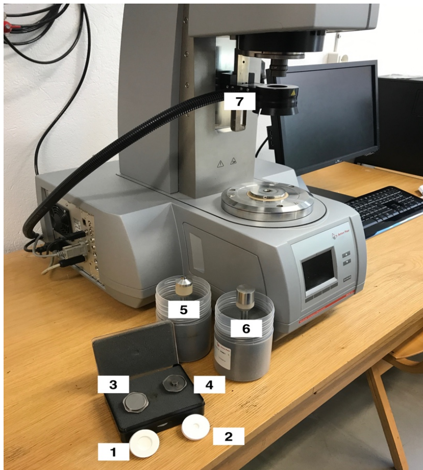
Figur 13 visar komponenterna till DSR:n. 1. Silikonform PP25, 2 silikonform PP08, 3. Undre mätplatta PP25. 4. Undre mätplatta PP08, 5. Övre mätplatta PP08, 6. Övre mätplatta PP25, 7. Temperaturkammare.
