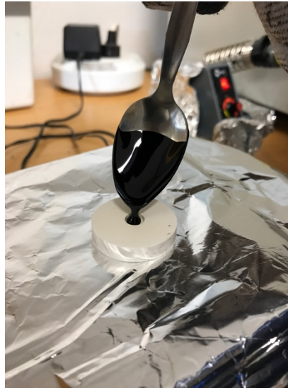
Figur 24 bilden till höger visar upphällning av bitumen. Bilden till vänster upphällning av bruk.
