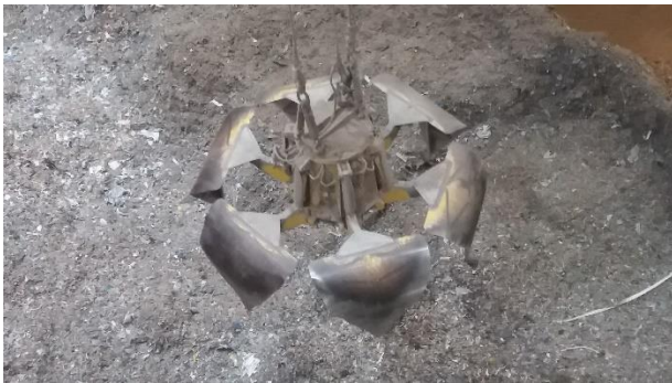
Figur 2. Bränsle fångas upp med en gripklo på Energiknuten.
