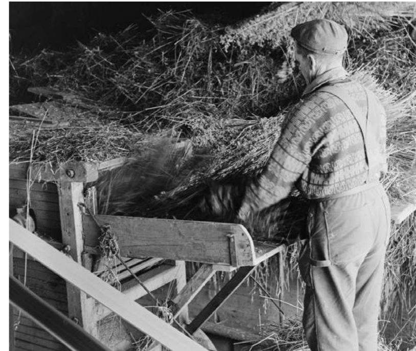
Figur 44. Skörden matas ned i en roterande cylinder där kärnorna skiljs från halmen, som slungas ut på en halmskakare och förs ut ur tröskverket.
