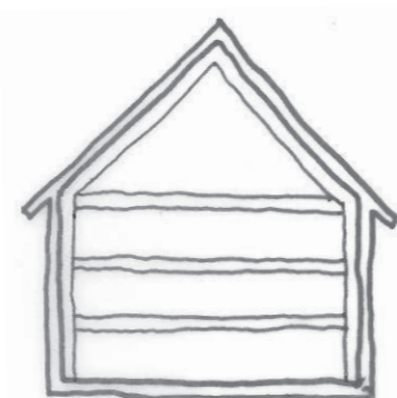
Nya bjälklag som kopplas ihop med ny tilläggsisolering på väggar/tak.
