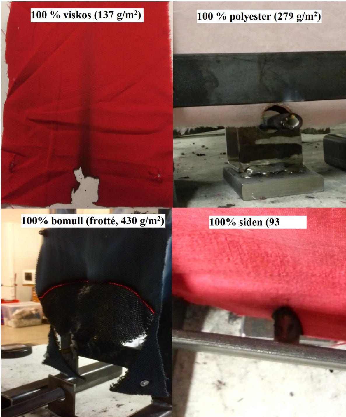
Figur 49 Förkolning. OBS! 100% bomull (frotté, 430 g/m 2 ) visar efterglöden efter 18 minuter.
