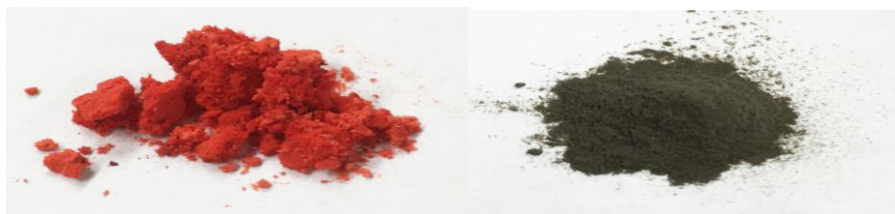
Figur 9 Rutenium på puralox, okalcinerad till vänster och kalcinerad till höger.
