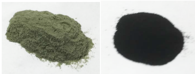
Figur 10 Nickel på puralox, oreducerad till vänster som är grön jämfört mot reducerad till höger som är tydligt svart.
