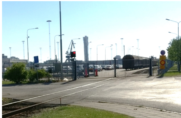
Figur 12. Oskyddad plankorsning med förenklad bevakning enligt alternativ 4 - vakt går före.
