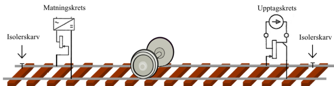
Figur 17. Spårledningskrets då spåravsnittet är belagt. Matningskrets till vänster, hjulpar som kortsluter spårledningen, och upptagskrets med ett faller spårledningsrelä till höger. När hjulparet befinner sig inom det av isolerskarvarna avgränsade spåravsnittet
