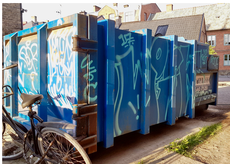
Figur 5 Containern, med komprimator, för restavfall som tillhör AF-borgens verksamhet, placerad på en betongplatta. (Foto taget av författare 2018-05-22)
