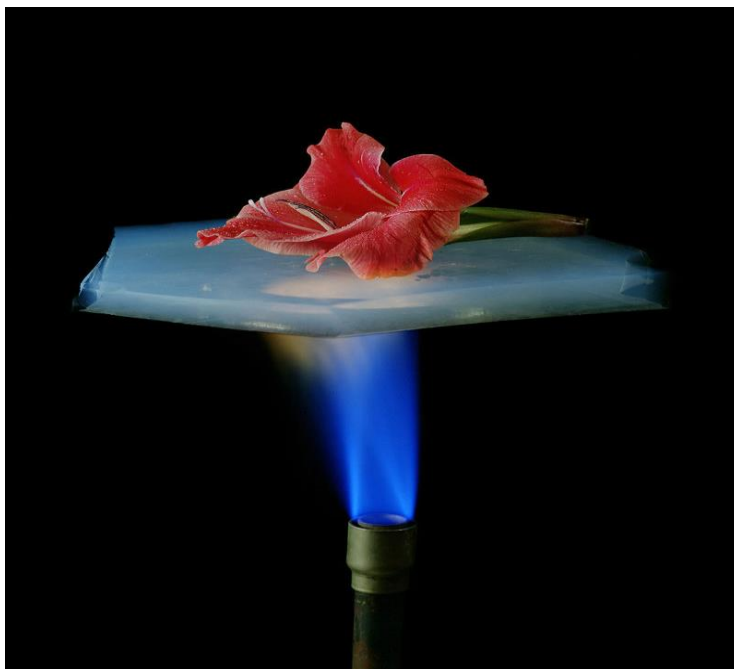
Figur 6.1 En bit aerogel skyddar blomman från flammen tack vare sin goda isoleringsförmåga.
