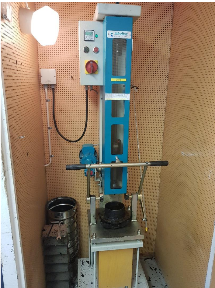
Figur 3.1: Marshallstampen som användes vid tillverkning av provkroppar
