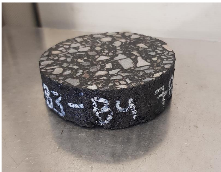
Figur 3.3: Sågad provkropp före prall-test
