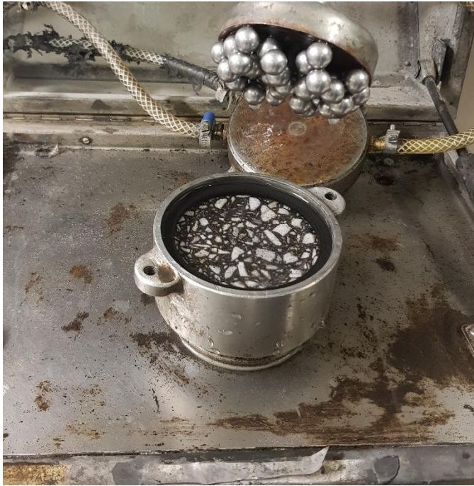
Figur 3.4: Provkropp i prall-maskin efter utfört test
