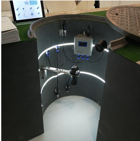
Bild 1: Microsensors system för att upptäcka översvämning i en brunn. Foto: Felix Wehrmann.
