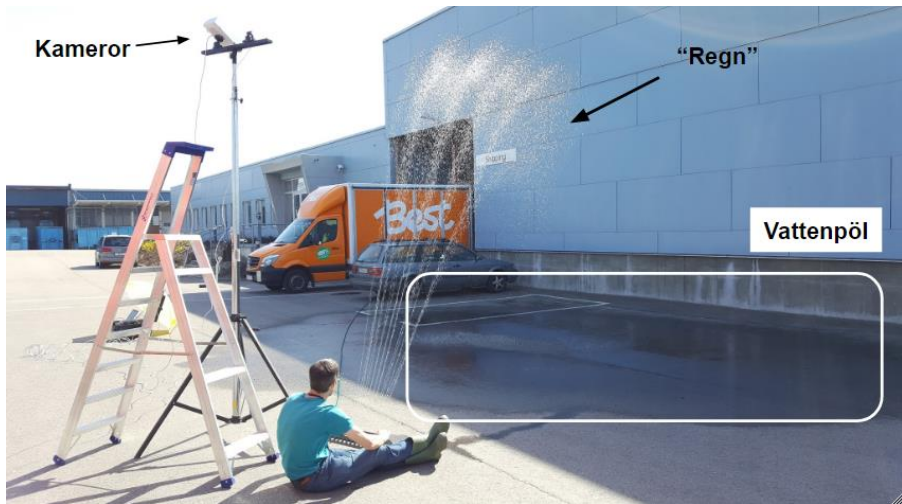
Bild 5: Uppställningen för simulering av regn.
