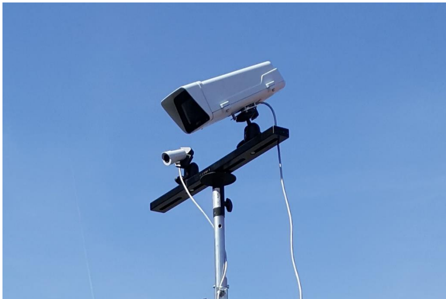
Bild 4: Kamerorna som användes vid simulering av regn. Den mindre kameran (t.v.) är en värmekamera, P1280-E, och den större (t.h.) är en vanlig kamera, P1367-E.
