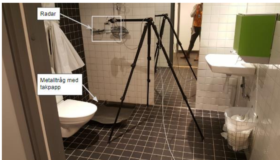
Bild 3: Uppställningen för test i dusch med radar. Bilden visar duschen där alla tester i dusch utfördes.
