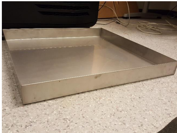
Bild 2: Metallträget som används för att samla upp vatten i de tester som skett i en dusch.
