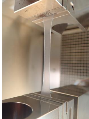
Figur 3. Hundben monterat i klämmor i dragtest-maskinen. Det dras sedan ut, för att mäta visa egenskaper på materialen som går att jämföra med varandra.
