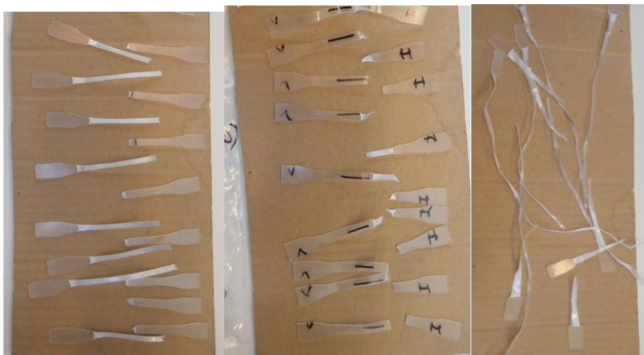
Figur 4. Bilder på hundben efter dragprovning. Hundbenen är stansade så som Figur 1 visar, i samma ordning.
