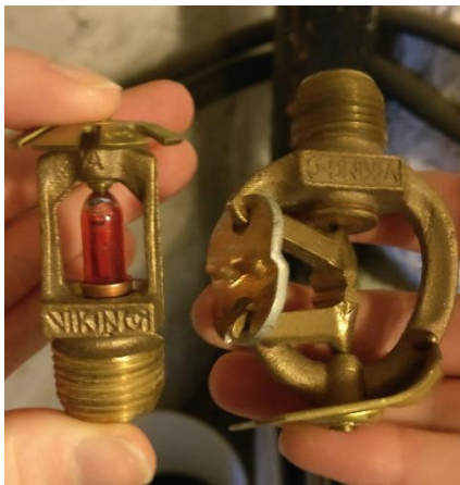
Figur 17. Sprinklerhuvud med tjock bulb samt sprinklerhuvud med smältbläck.
