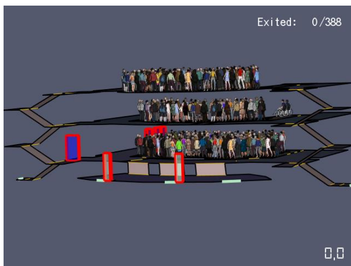
Figur 37. Simuleringen uppsatt i Pathfinder, med rödmarkerade dörrar som inte kan användas.
