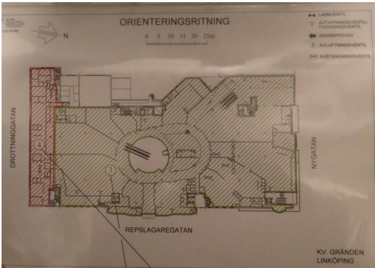
Figur 116. Sprinklersektion tre och fyra på våningsplan två.
