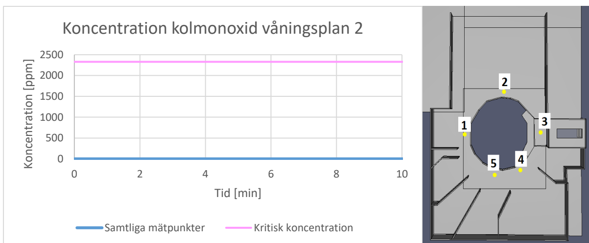
Figur 93. Den i FDS beräknade koncentrationen kolmonoxid på våningsplan två för scenariot Brand i utställningsbil.
