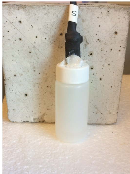
Bild 2. Provampull försedd med RF-sensor. Ampullerna placerades i kalorimetern med RF-sensorer enligt denna bild.
