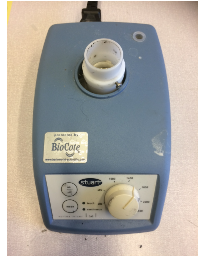
Bild 7. Vortex-blandaren som blandade samtliga prov innan de fördes ned i kalorimetern.
